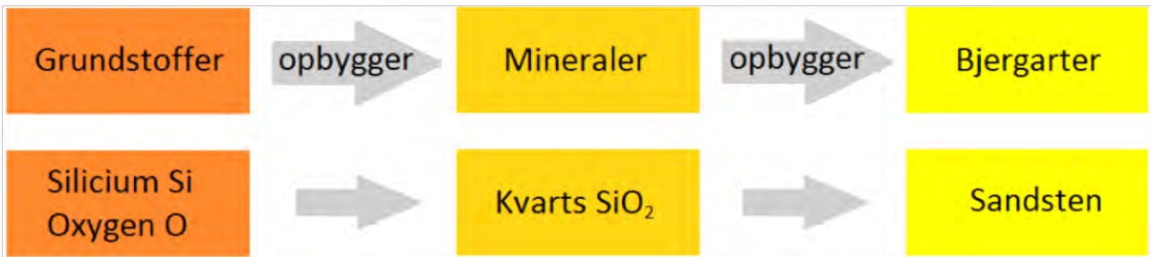
Figur 4: Grundstoffer opbygger mineraler, og mineraler opbygger bjergarter. F.eks. kunne silicium og oxygen gå sammen og danne mineralet kvarts. Hvis flere kvartskorn sidder sammen, danner de en sandsten.
