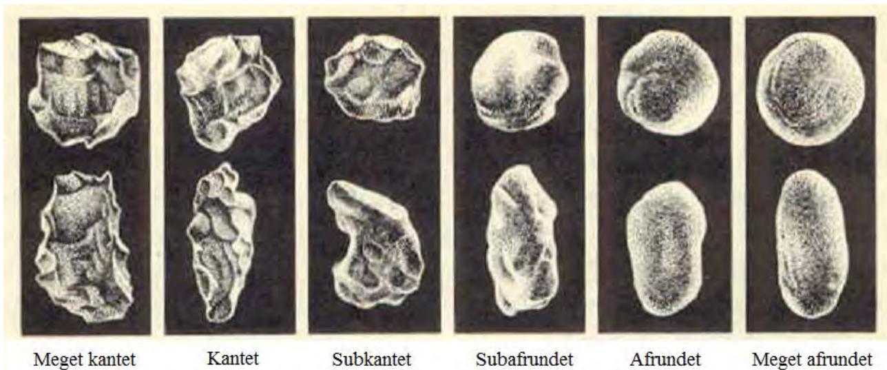
Figur 11: Viser inddelingen af korn efter afrundingsgraden (Tucker, 2003)
