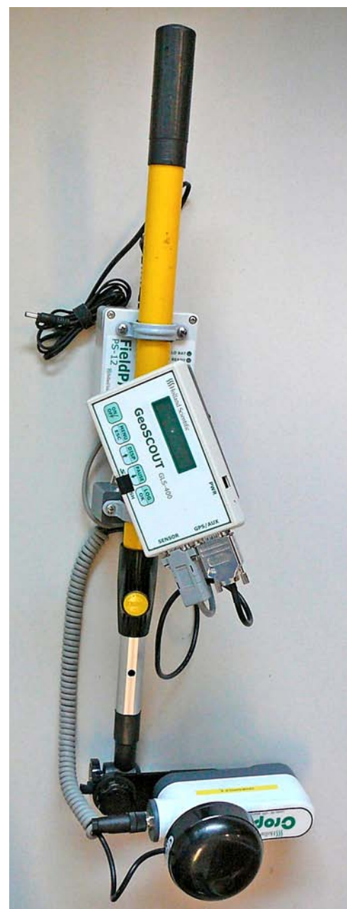
Figur 5 En Crop-circle med sensorhed med lyskilde og GPS til måling af NDVI. Foto: © Katrine Ravndrup.
