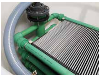
Ultrafiltreringsmembran i containerløsning fra Sunstone Water Group.
