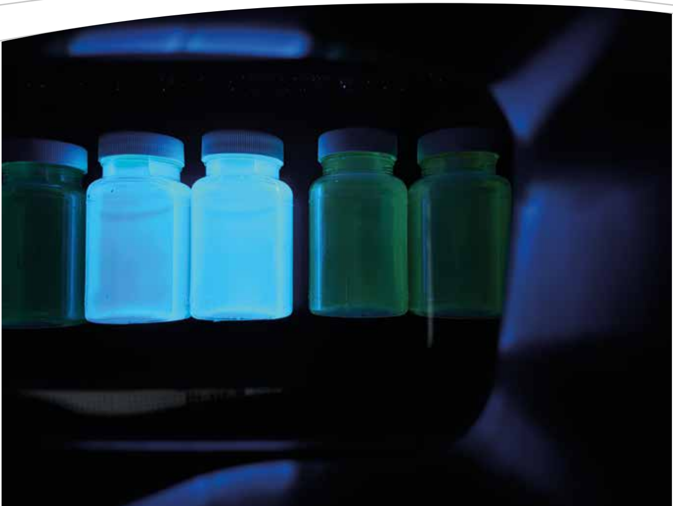
Prøver af havvand fra Ilulissat taget henholdsvis før og efter rensning. Selvlysende prøver, taget før rensning, er positive for Enterokokker, hvorimod ikke selvlysende prøver, taget efter rensning, er negative.
