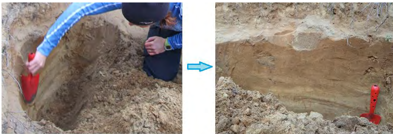
Billede 3: Forberedelse af profil, Nordnorge. Skrab med en kniv eller skovl langs med de sedimentære lag for at opnå det bedste overblik af aflejringerne (foto af Søren Nielsen).
